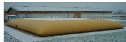
résistance à la déchirure et garanti l'absence d'air à l'intérieur du réservoir. Le volume d'un réservoir souple est en standard de 1 à 500 m<sup>3</sup> et possède 1 évent de diamètre 120 à 150 sur le dessus avec bouchon vissable, 1 trop-plein coudé 90° et 1 ou plusieurs entrées et sorties avec vannes. Sa taille est compacte une fois plié.
